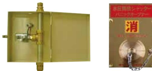
水圧スイッチと組み合わせて、火災時等の非常時に外部から消防ホースの水圧を利用して、停電時でも人が通れる高さまでシャッターを開放する装置です。F型開閉機の200V仕様及びH62型開閉機で対応できます。
