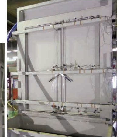
水防扉II(開き戸タイプ)の止水性能試験(両開き)
