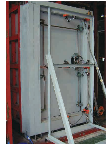
水防扉(開き戸タイプ)の止水性能試験(片開き)
