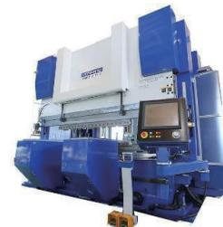
本件事業採択設備：サーボ駆動式機械プレス
